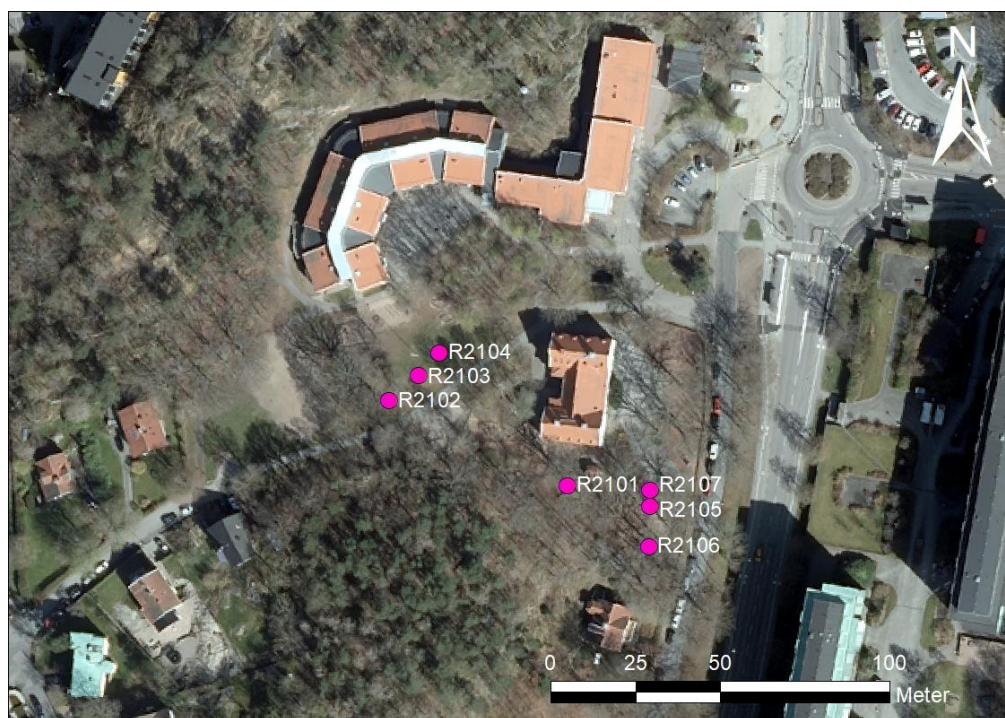
Figur 3. Provpunkter i samband med geoteknisk undersökning (R2101-07). I två provpunkter, R2104 och -05 uttogs prov för analys av föroreningar.
